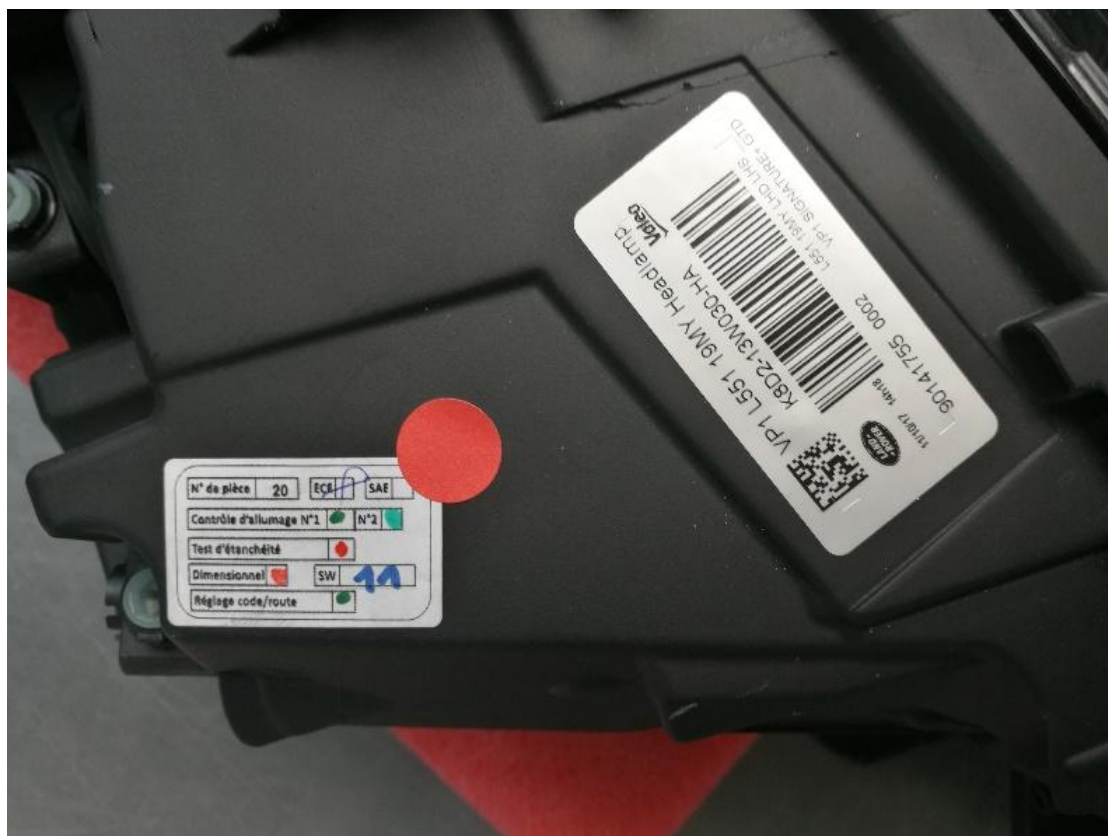
FIGURE 21. – Étiquette de traçabilité interne (à gauche) et étiquette produit (à droite) répertoriant la référence associée au type de projecteur
